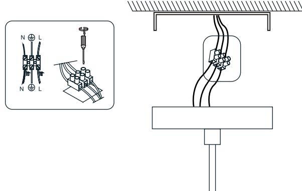
3 - Encaixe a luminária na travessa, encostando no teto e fixe-a através dos parafusos laterais.
