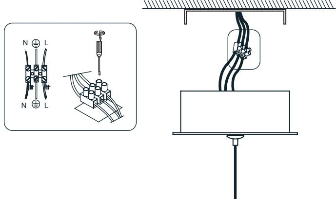
3 - Encaixe a luminária na travessa, encostando no teto e fixe-a através dos parafusos laterais. Ajuste a altura desejada pressionando o botão central do prensa-cabo e movimentando o cabo; para travar, basta soltar o botão. Importante: caso a instalação não precise do comprimento total do cabo, corte o excesso antes de encaixar a canopla.
